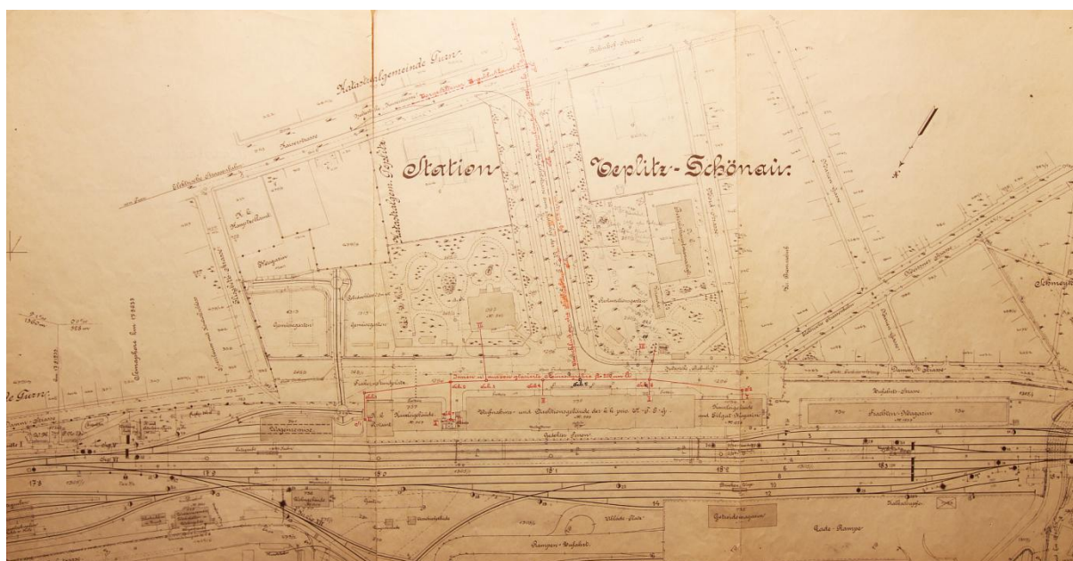
30. Detailní situační mapa železničního nádraží se zákresem vodovodu a kanalizace, 1916 [MěÚ Teplice, archiv stavebního úřadu].
